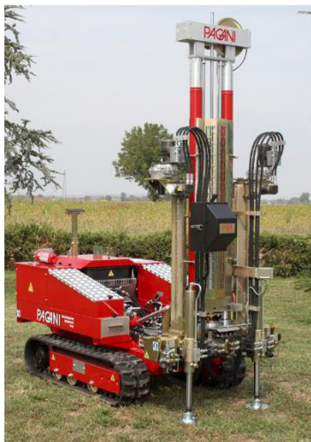
Fig. 3.1. Penetrometro PAGANI modello TG 63-100
